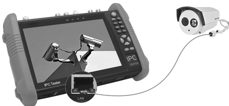
1: Falls die Kamera Stromversorgung über POE benötigt, verbinden Sie diese mit dem LAN Port des Testers. Das Gerät stellt dann POE Spannung zur Verfügung. Klicken Sie im Menü des Testers auf das Icon „POE“ um die POE Versorgung an und auszuschalten.
