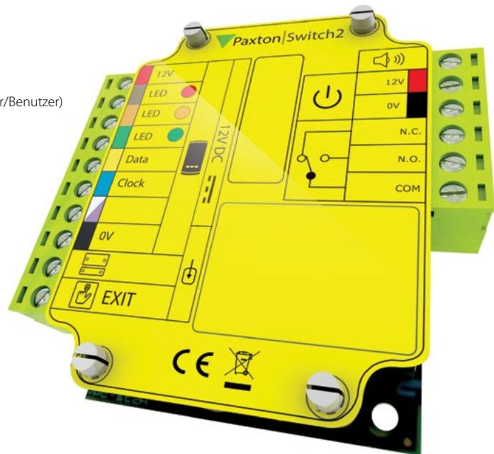
Switch2 ist eine Standalone-Türsteuerzentrale für eine Tür. Eine Switch2 Türsteuerzentrale wird an der sicheren Seite der Tür angebracht und der Leser an der anderen Seite. Die Switch2 Türsteuerzentrale speichert alle Zutrittsbefugnisse für Nutzer im Gerät; das bedeutet, auch wenn der Leser manipuliert ist, bleibt die Tür sicher.
