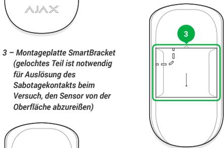
3 – Montageplatte SmartBracket (gelochtes Teil ist notwendig für Auslösung des Sabotagekontakts beim Versuch, den Sensor von der Oberfläche abzureißen)
